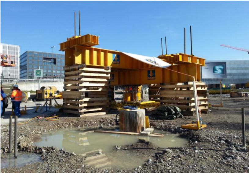
*Aufbau für statischen Pfahlbelastungsversuch. Prüfpfahl mit Presse in Mitte, vier Reaktionspfähle (Zug) sowie Stahljoch. Im Vordergrund: Für Versuch vorbereiteter Pfahlkopf.*
