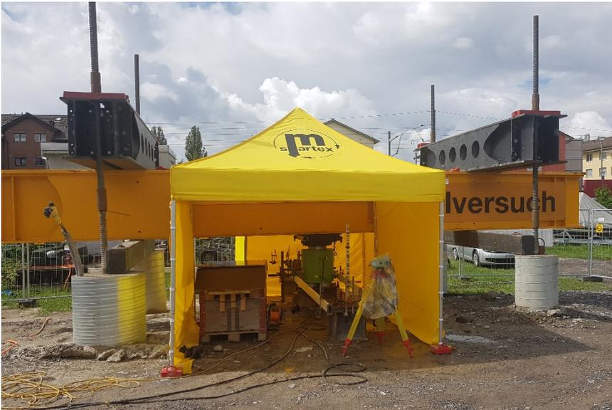
*Aufbau für statische Pfahlbelastungsversuche. Prüfpfahl mit Presse und Überwachungseinrichtungen in Mitte, 4 Reaktionspfähle (Aufbetoniert mit Blech-Spiralrohr und GEWI-Zugglied) sowie Stahljoch. Reaktionspfahl links mit überstehenden Sonden für TRT-Messung.*
