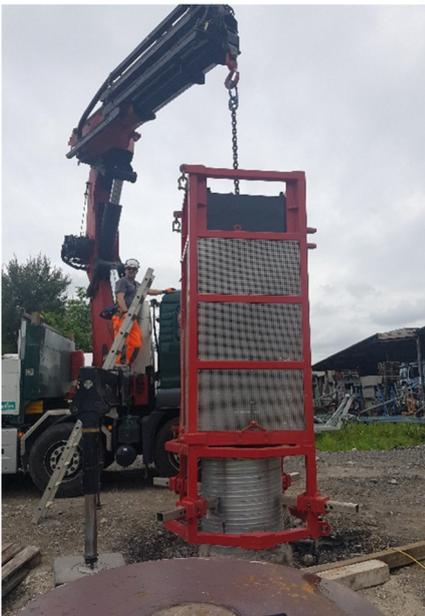
*Belastungseinrichtung für dynamische Pfahlversuche (10 t Fallgewicht) und Prüfpfahl (Aufbetoniert mit Blech-Spiralrohr)*
