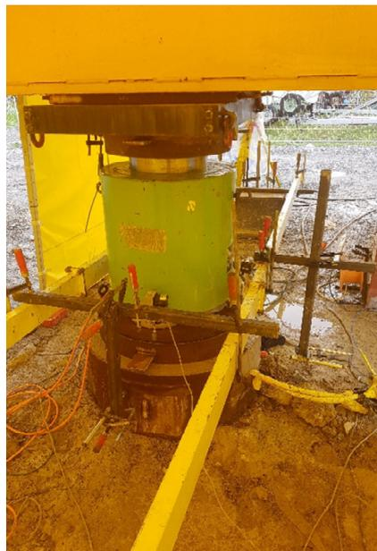
*Pfahlbelastungsversuch. Pfahlkopf des Prüfpfahls 1 mit hydraulischer Presse und Wegaufnehmer.*
