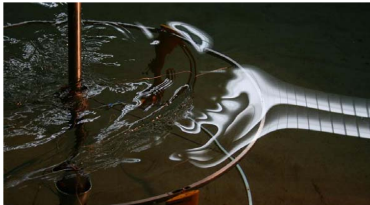
Abbildung 42: Verformung der Wasseroberfläche bei minimaler Tauchung
