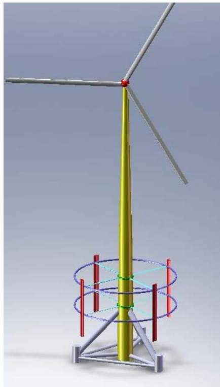
Abbildung 33: Gesamtstruktur H-Rotor mit Tripod-Gründung
