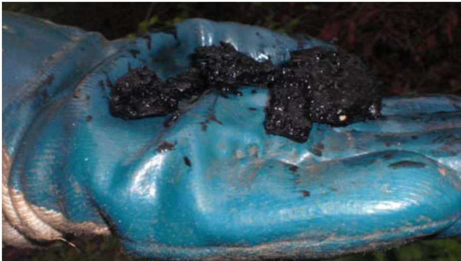
Ausgespülte feste Ablagerungen
