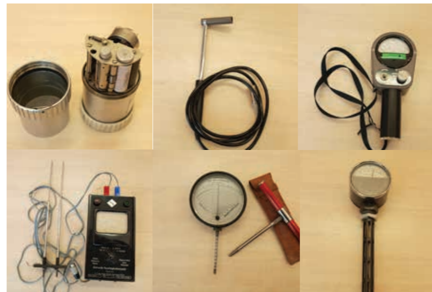
In den 1950er- bis 1970er-Jahren verwendete Messinstrumente zur Untersuchung der meteorologischen Bedingungen im Laderaum und des Feuchtegehaltes ▼ gefährdeter Ladung wie Holz und Getreide
