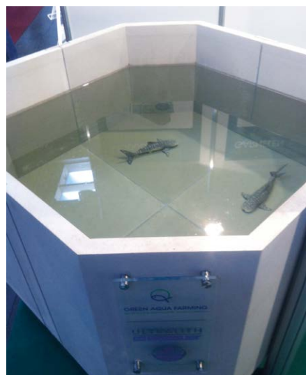
Bild 20: Fischzuchtbecken aus miteinander verklebten UHPC-Platten.
