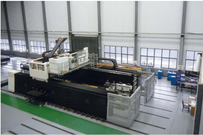
Bild 19: Portalfräsmaschine chinesischer Produktion (Fa. Yonghua, China, Fotos Rottler)
