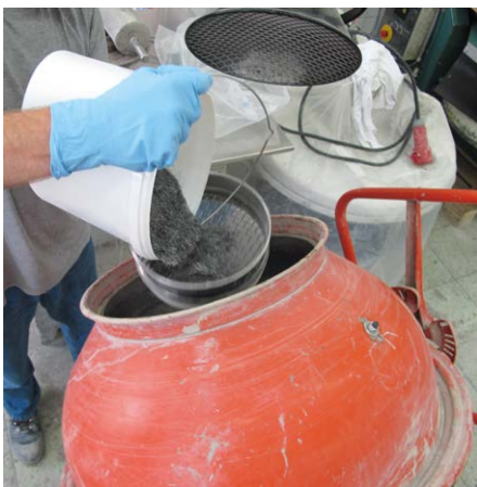
Bild 16: Herstellung von UHPC mit Nanodur® Compound 5941 im Trommelmischer
