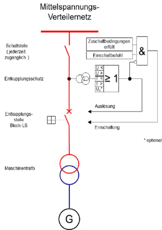
Abbildung 12: Netzanschluss an das Mittelspannungsnetz mit Netzentkopplungsschutz
