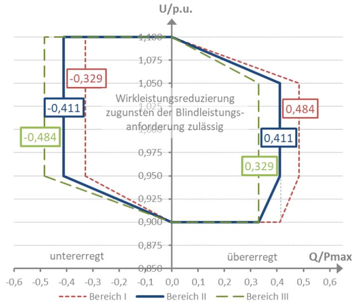
Abbildung 6: Blindleistungsbereiche synchroner und nichtsynchrone Stromezeugungsanlagen bei Maximalkapazität
