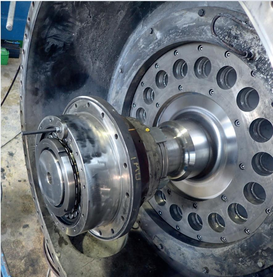
Vormontage der Lagerung einschließlich Gleitringdichtung
