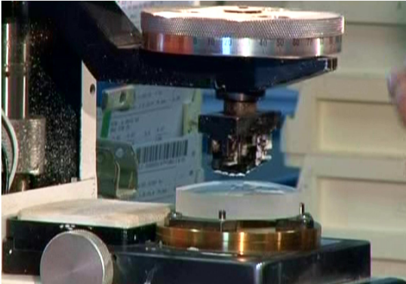
Abb. 96: Ausrichten und Stempeln des Presslings [Jena2009-2]
