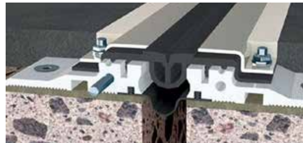
6 Dodatočné tesnenie a) trhliny, b) pracovnej škáry v základovej doske injektážou [9] 7 Dodatočné tesnenie dilatačnej škáry a) pod vnútorný pás, b) pod vonkajší pás v základovej doske clonovou injektážou [9] 8 Podhľad presakujúcej dilatácie stropu 9 Rez vodotesným dilatačným zariadením pojazdného stropu [10]
