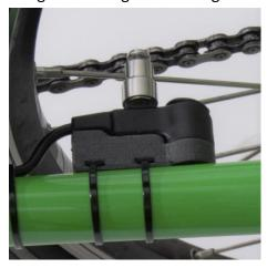
Tipp: Bei einer falschen Positionierung des Magneten zum Gehäuse oder bei zu viel Abstand zwischen den beiden Komponenten erfolgt keine Geschwindigkeitsanzeige und auch keine Motorunterstützung.
