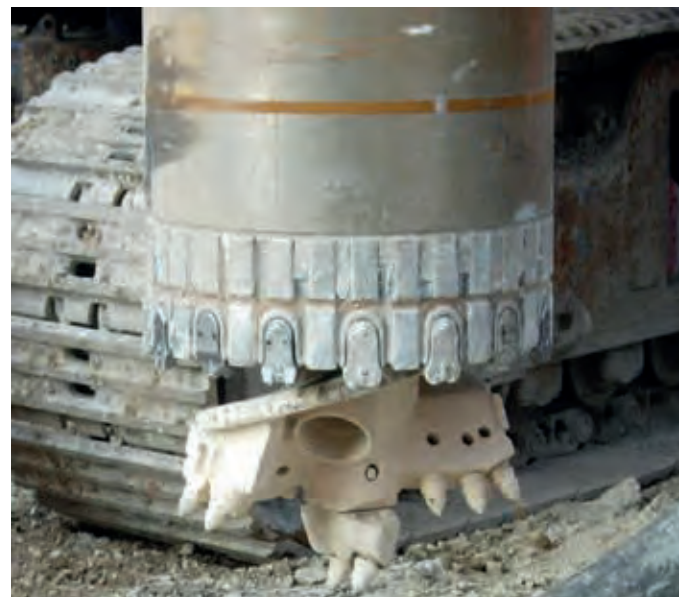
Rundschaftmeißel für Kies, Schotter und Felseinbindung Bullet teeth for gravel, cobbles and rock socketing
