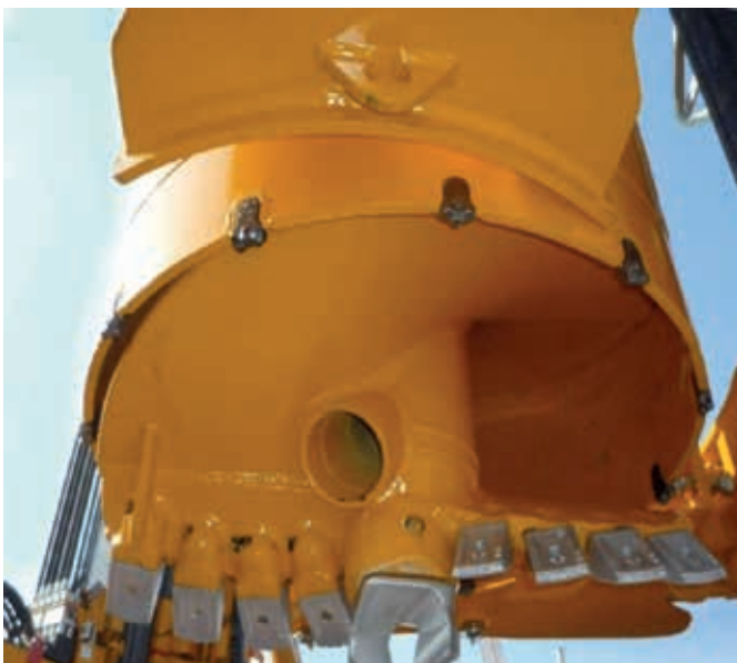
Flachzähne für weiche Böden (Lehm) und Sand Flat teeth for soft soils (clay) and sand
