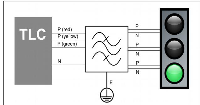
Blockschema: Filterbord FIB zwischen TLC und Ampel
