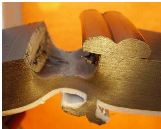
Bild 10: Bruchfläche der Probe V6 (Bruchausgang Nahtkante außen, Bruchverlauf außerhalb der Fügeebene), Quelle: Hessel Ingenieurtechnik
