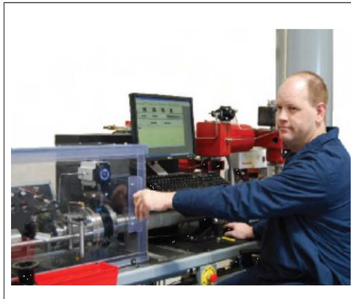
PDCL-Prüfstände sind vollautomatische Kalibriereinrichtungen. Das gewünschte Volumen wird automatisch eingestellt und die Prüfstände sammeln sämtliche Kalibrierdaten. Sie verfügen auch über eine Schnellspannvorrichtung zur OEM-Zählerkalibrierung.
