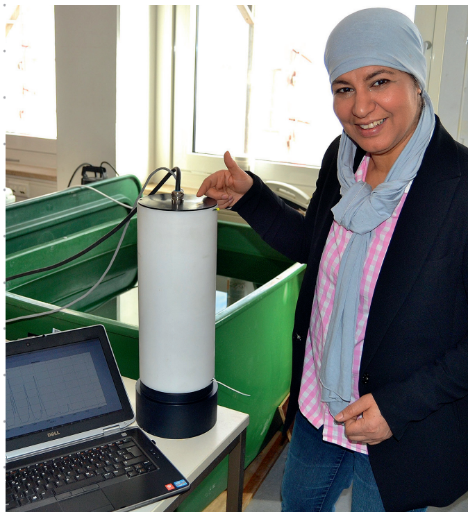
Prototyp im Laboreinsatz: Projektleiterin Prof. Dr.-Ing. Sabah Badri-Höher demonstriert das EECole-System zur Kolküberwachung. Die elektronischen Komponenten sind in einem Druckkörper integriert, der Wassertiefen bis 50 Meter widerstehen kann.
