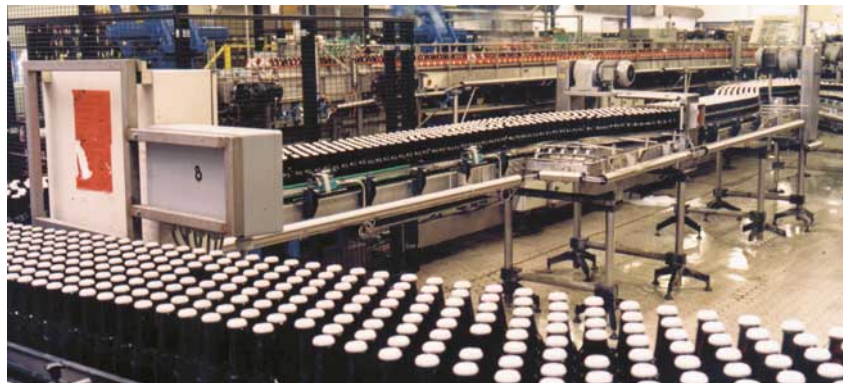
Bild 1: Die Abfülllinien bei Bavaria N.V., Lieshout, der zweitgrößten Brauerei Hollands, beginnen bei der Entpalettierung und enden an den Palettierern; als übergeordnetes Leitsystem arbeitet das PC-basierte Automatisierungssystem 4Control von Softing
