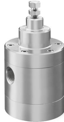
Die TESCOM Serie 26-2900 sind Dome gesteuerte Vordruckregler für Folgeregelungen mit negativen BIAS und vordruckausgeglichenem Hauptventil. Zur Vordruckregelung bis 69,0 bar mit Federvorspannungseinstellung.
