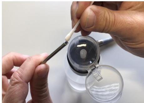
Fig. 2: Pulizia dell'estremità distale
