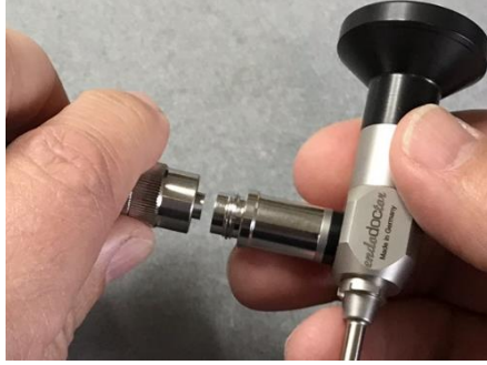
Şek. 5: Bir fiber optik kablunun dişliyle (*Storz, *Olympus tedarikçileriyle uyumlu) bağlanması
