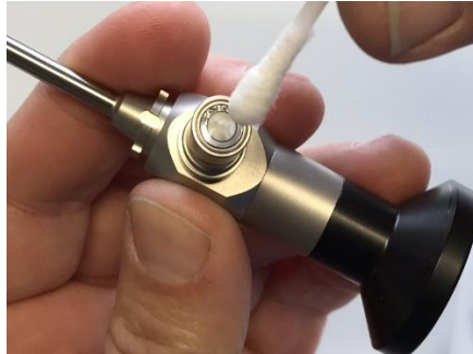
Fig. 3: Limpieza del accesorio de guía de luz
