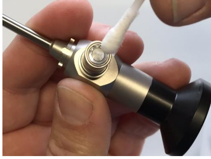
Şek. 3: Işık kılavuzu bağlantısının temizlenmesi
