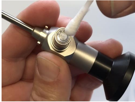
Fig. 3 : Nettoyage de la fixation du guide optique
