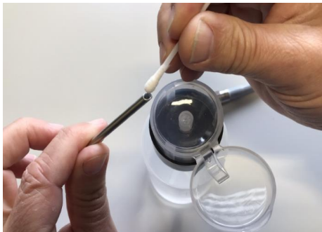
Fig. 2: Limpieza del extremo distal
