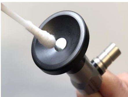
Рис. 4. Очистка проксимального окна
