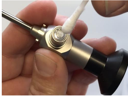
Sl. 3: Čišćenje nastavka svetlosnog vodiča
