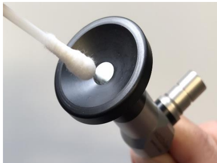
Fig. 4: Pulizia della finestra prossimale
