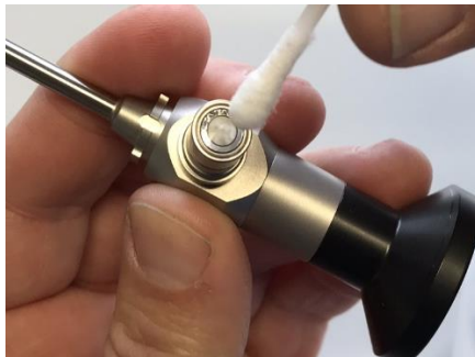
Obr. 3: Čištění adaptéru světlovodu
