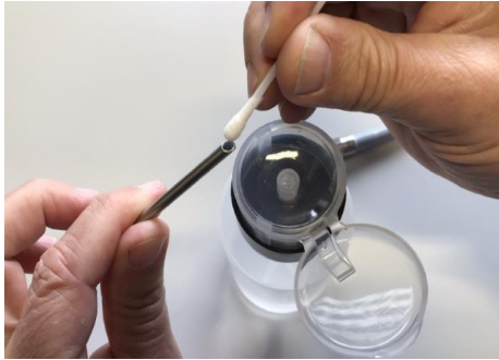
Şek. 2: Distal ucun temizlenmesi
