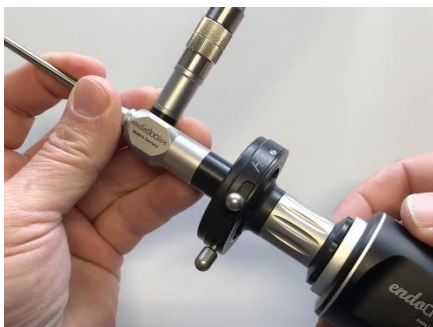
Abb. 9: Aufsetzen einer Endoskopie Kamera am genormten Okulartrichter
