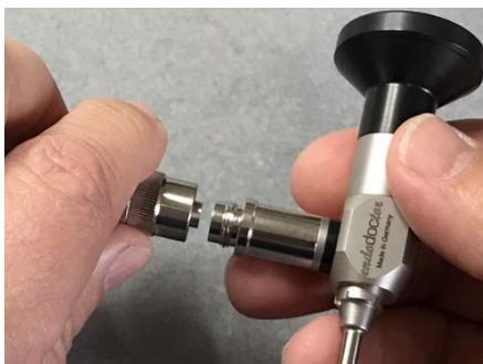
Fig. 5: Conexión de un cable de fibra óptica con rosca (compatible con los proveedores *Storz y *Olympus)
