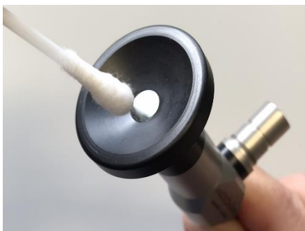
Obr. 4: Čištění proximálního okénka
