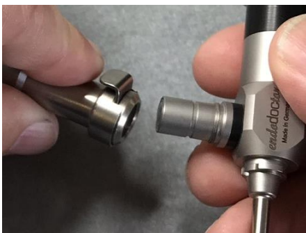
Fig. 6: Conexión de un cable de fibra óptica con mecanismo de fijación a presión (compatible con *Wolf) Se retira el primer manguito de la fijación del cable de fibra óptica
