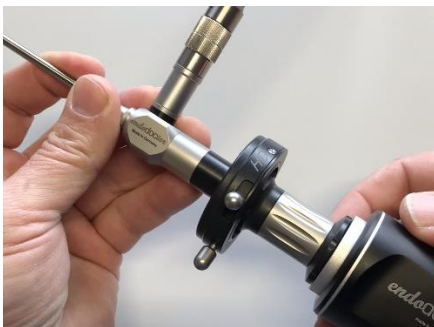
Рис. 9. Размещение эндоскопической камеры на стандартизированной окулярной воронке
