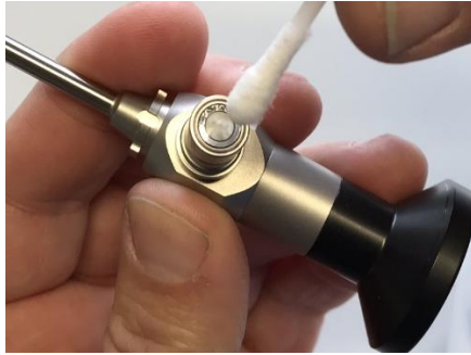
Fig. 3: Het lichtgeleiderhulpstuk reinigen
