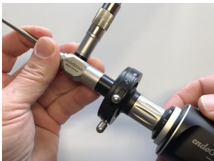
Fig. 9: Een endoscopiecamera op de gestandaardiseerde oculaire trechter plaatsen
