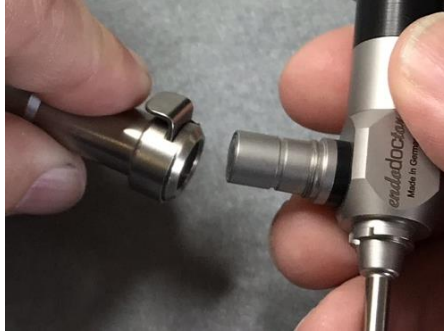
Şek. 6: Bir fiber optik kablunun mandallı mekanizmayla (*Wolf ile uyumlu) bağlanması. Fiber optik kablo bağlantısının ilk manşonu sökülür
