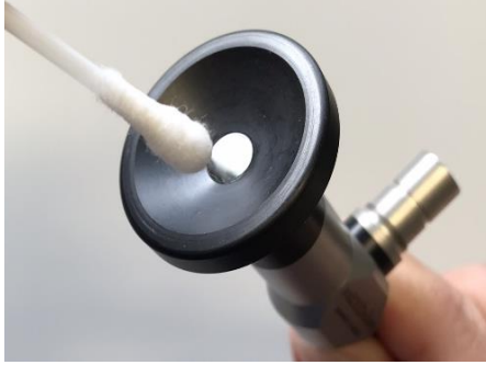
Şek. 4: Proksimal Pencerenin temizlenmesi
