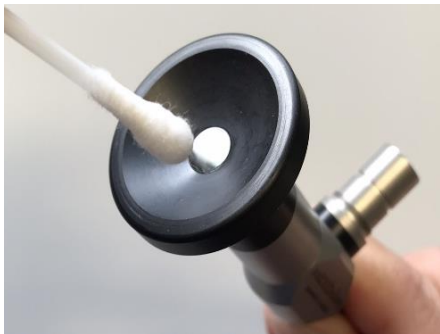
Fig. 4 : Nettoyage de la fenêtre proximale
