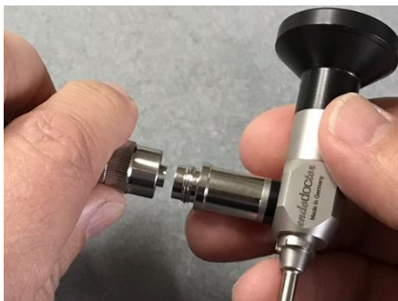
Obr. 5: Připojení kabelu s optickými vlákny se závitem (kompatibilní s dodavateli produktů *Storz, *Olympus)
