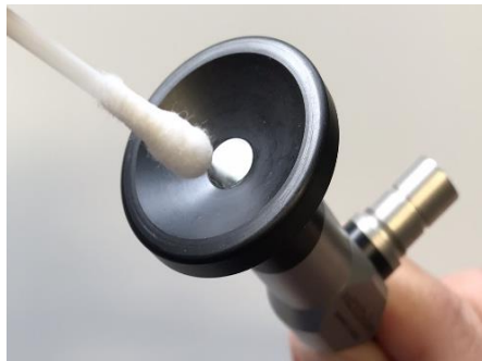
Fig. 4: Limpieza de la ventana proximal
