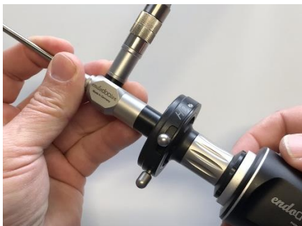
Fig. 9: Colocación de una cámara endoscópica en el embudo ocular estándar
