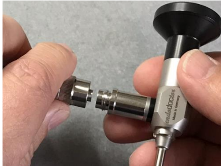
Fig. 5: Aansluiting van een glasvezelkabel met schroefdraad (compatibel met de leveranciers *Storz, *Olympus)
