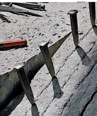
Spalten von Gneis zu Platten.
