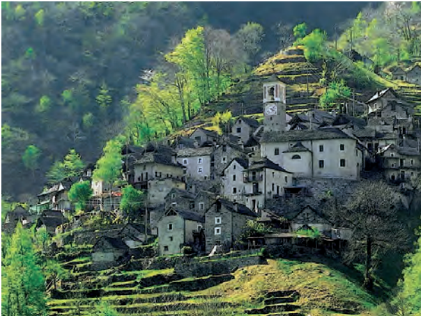
Die Dächer in Corippo in der Valle Verzasca (Tessin) sind mit Gneisplatten gedeckt.
