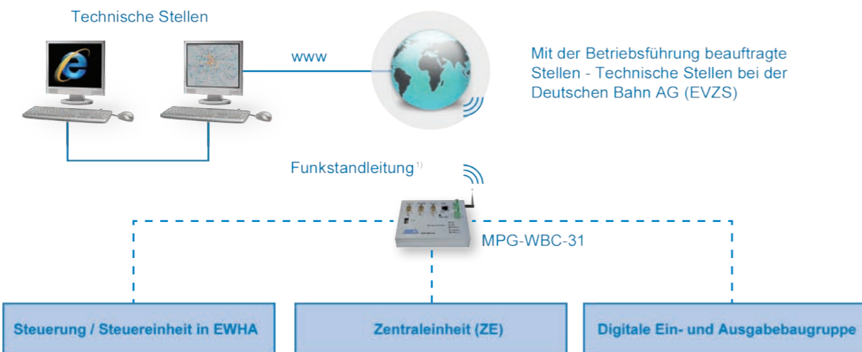
Anlagenbindung mit dem Multiprotokollgerät MPG-WBC-31 (WEB-Connector) über Funkstandleitung
