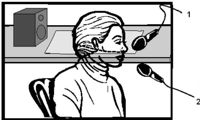
Bild 2 – Versuchsanordnung zur Messung des Übersprechens mit Person.
