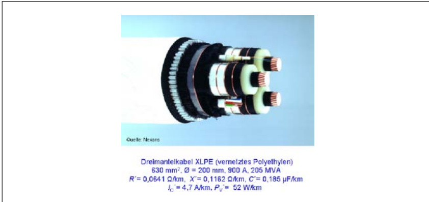
Abb. 5.3: Daten eines 145-kV-Drehstromkabels
