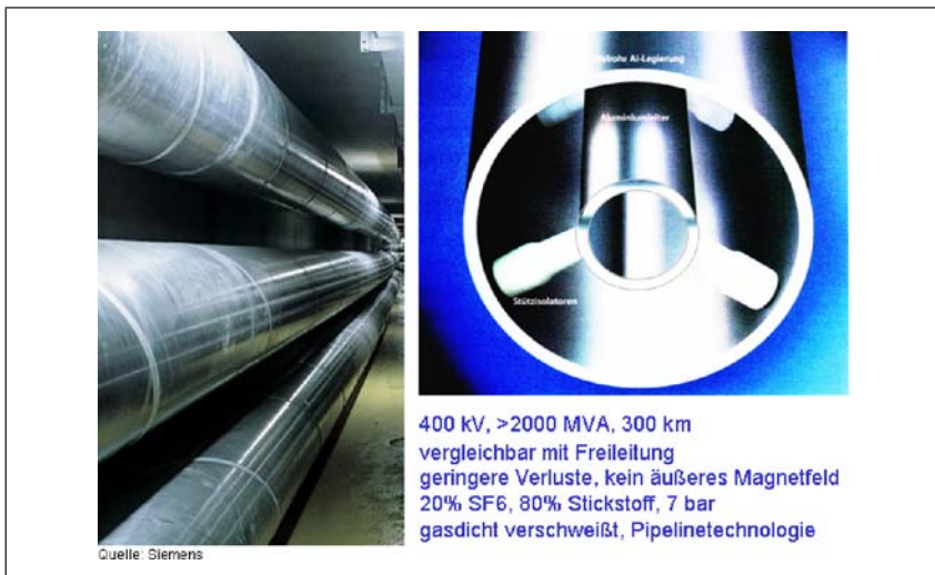
Abb. 6.8: Gasisolierte Rohrleiter (GIL)
