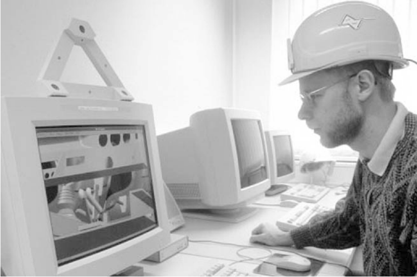
Abb. 3.7: Räumliches Sehen durch Bewegungsparallaxe (Versuchsaufbau am IPP der TUC)
