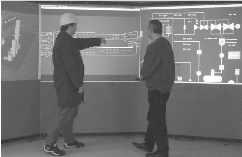
Abb. 3.9: MDD in Kombination mit einem verfahrenstechnischen Schema und einem 3D Display
