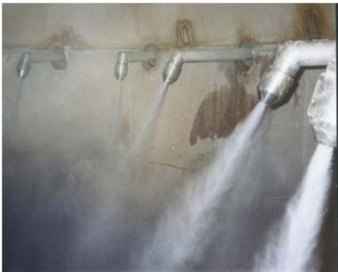
Abbildung 3: Sprühabsorber inklusive Anordnung der Zweistoffdüsen [4][6]
