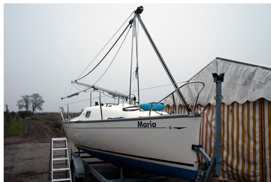
Optional kann der zusätzlich mitgelieferte U-Beschlag bugseitig am Mast befestigt werden. So kann der Tote Mann bei gestelltem Mast platzsparend an den Mast geklappt und durch den Beschlag aufgenommen werden. Dadurch muss der Tote Mann zwischen den Manövern nicht vollständig demontiert werden und der Bugbereich ist trotzdem frei.
