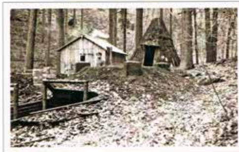
Vorn Meilerofen mit verschließbarer Beschickungs- und Entleerungsöffnung, dahinter vier regelbare Rauchabzüge über dem abgedeckten Meilerofen.
