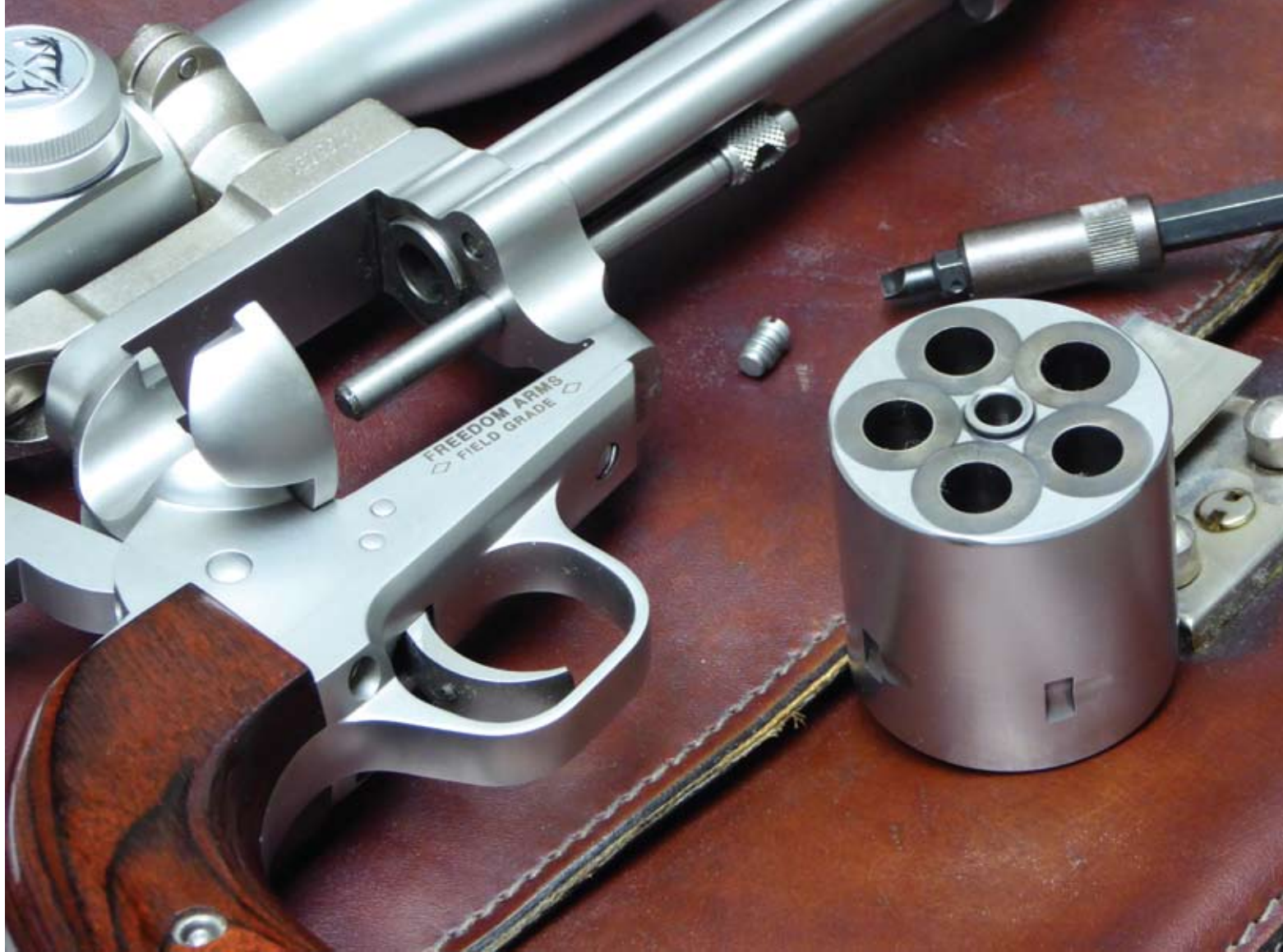
Revolver zerlegt, Ladeklappe offen. Man beachte, das durch den hohen Gasdruck und dem engen Trommelspalt entstandene Ornament auf der Stirnseite der Trommel
