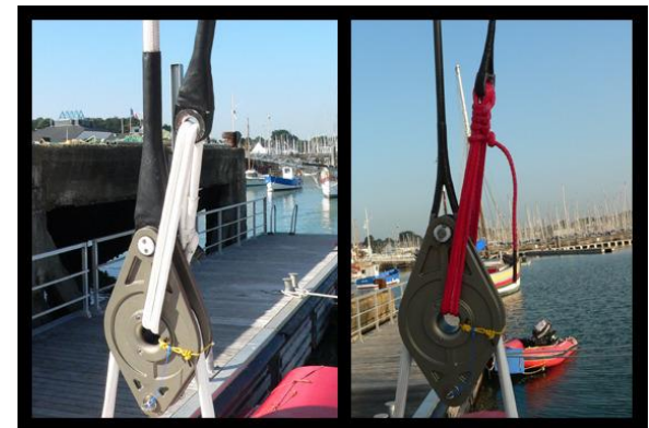
Vergleich zwischen gewöhnlichen Schlaufen mit Schlaufen aus Kohlenfasern
