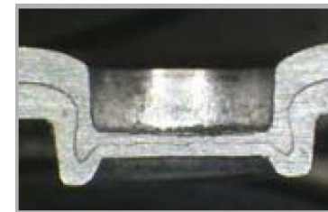
Querschliff des Durchsetzfügens von Metallen
