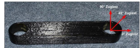
Querlenker Schlaufe mit Lastrichtungen
