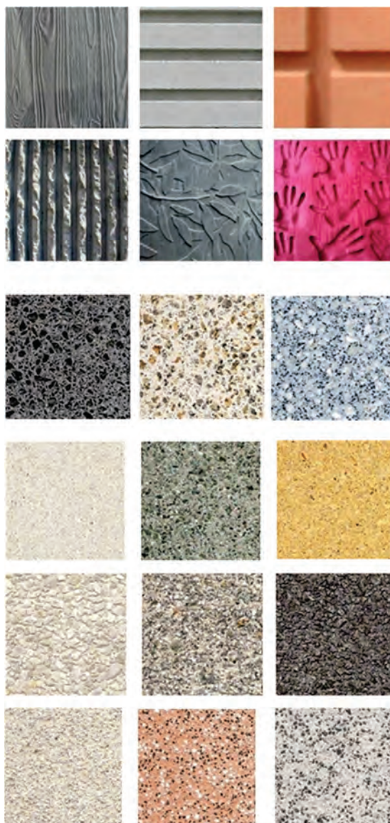
Bild 80: Beispiele für die Oberflächen von Betonfertigteilen
