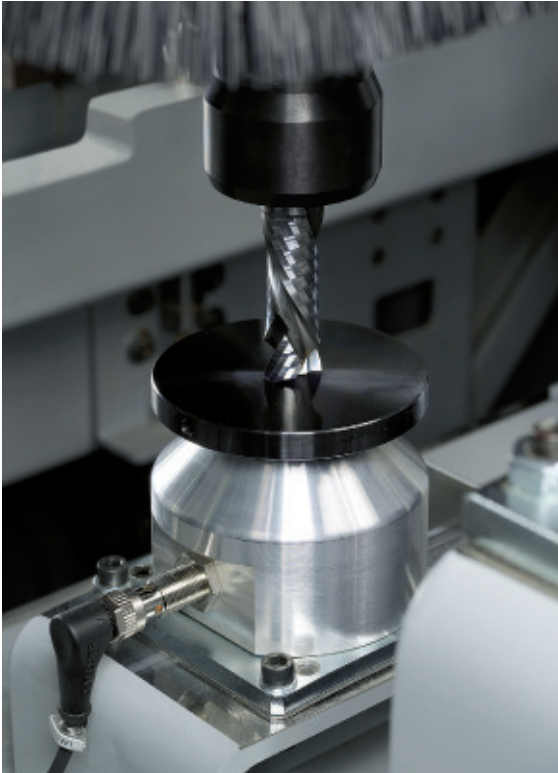
Das Bearbeitungszentrum ist sowohl mit einem Werkzeuglängen- als auch mit einem Werkstückmesssystem ausgestattet.
