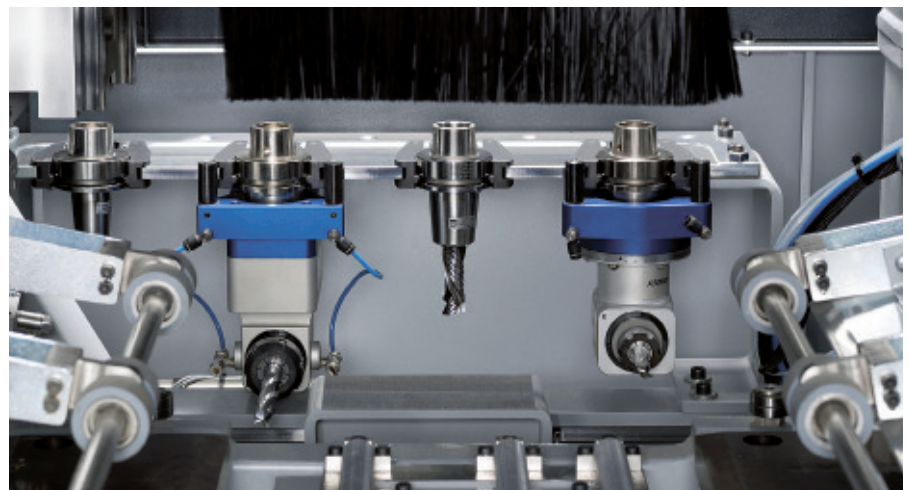
Der Linearwechsler sorgt für einen besonders schnellen Werkzeug- und Aggregatwechsel.
