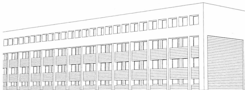
Gestaltverlust durch Verblechung und Außendämmung: statt ansprechenden „Stapelwerks“ aus gleichartigen, kleinteilig gefügten Geschossen ein allzu grobschlächtiges, falsch wirkendes „Tischsystem“
