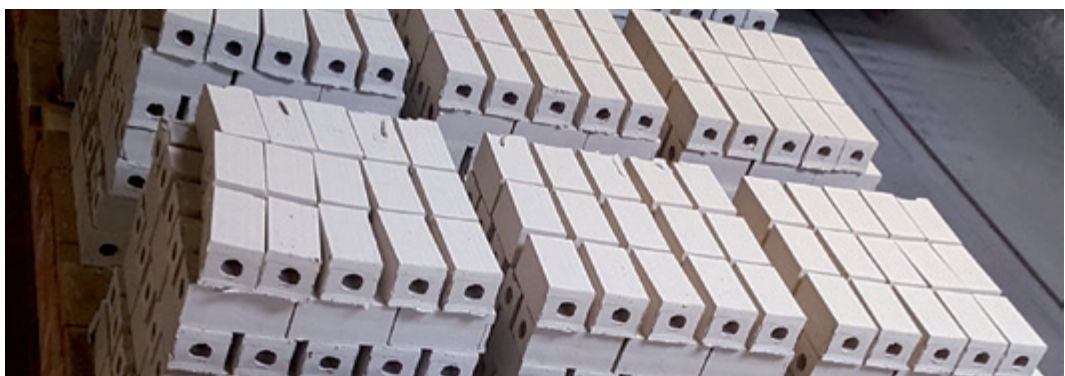
Abb. 12.2: Gepresste Batzen zum Schamottebrand (Quelle: KTS).
