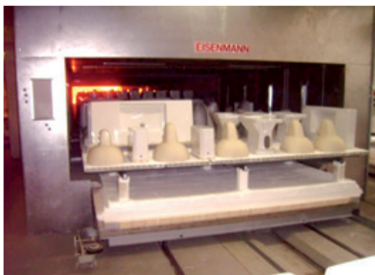
Abb. 12.1: Tunnelofen zum Brand von Sanitärkeramik (links, Quelle: Eisenmann) und Herdwagenofen mit seitlicher Gasbefuerung (rechts, Quelle: Rath).
