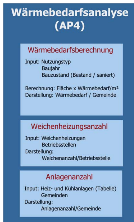
Abbildung 79: Wärmebedarfsanalyse und Wärmebedarfsberechnung
