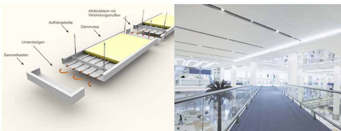
Abbildung 62: Aufbau und Anwendung von Heiz-/ Kühlpanelen ( www.sunline-heizflaechen.de )
