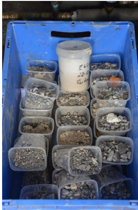
Abbildung 54: Bohrklein einer Erdwärmesonde
