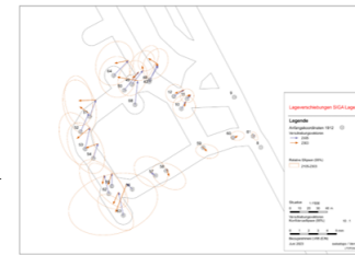
Abb. 8: Verschiebungsvektoren in den Galerien 04 und 18 (2019 – 2021 – 2023)
