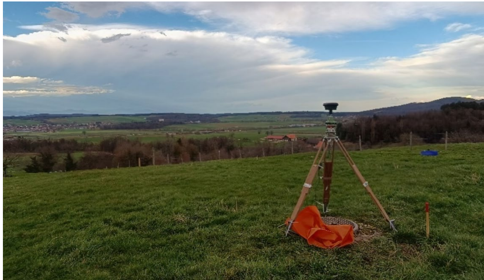
Abb. 6: Aufbau GNSS-Station bei Punkt 201
