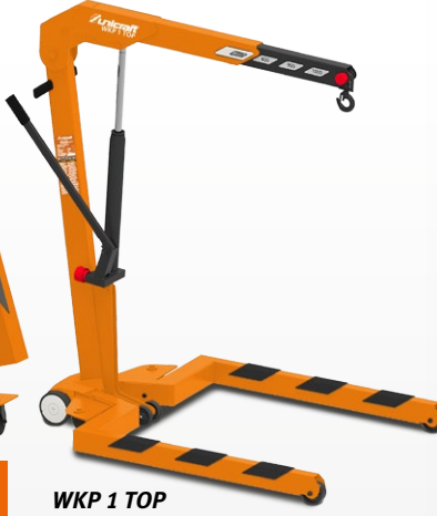
Patentierter ausfahrbarer Ausleger mit Skala
