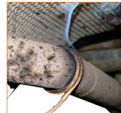
▶ Schwer zugängliche Teile können durch den Einsatz und entsprechende Anbringung von speziellem Wickeldraht gelöst werden
