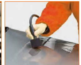
▶ Zur Ausbesserung von Hagel-Dellen ohne Beschädigung des Lackes
