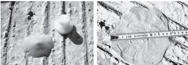
**Bild 75.** Messung der Rautiefe  $R_t$  nach Kaufmann (Beispiel:  $R_t \approx 1,4 \text{ mm}$ ); a) Definierte Sandmenge (Beispiel:  $V = 25 \text{ cm}^3$ ), b) Durchmesser der verteilten Sandmenge (Beispiel:  $D \approx 15 \text{ cm}$ )
