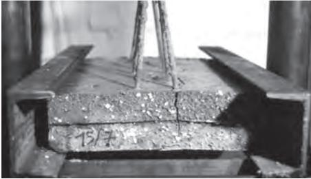
**Bild 133.** Biegebruch der Fertigteilelemente in Versuchen [164]
