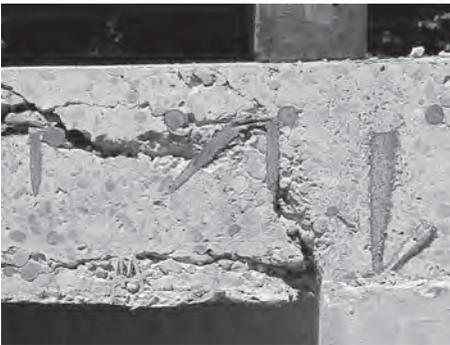
**Bild 96.** Schnittbild eines Versuchskörpers nach einem Durchstanzversagen [130]
