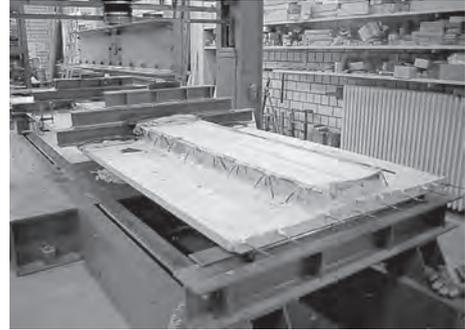
**Bild 49.** Traglastversuch an einer Höckerdeckenplatte aus [80]
