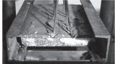
**Bild 134.** Herausreißen der Gitterträgeruntergurte bei Betondeckungen unter 12 mm in Versuchen [164]
