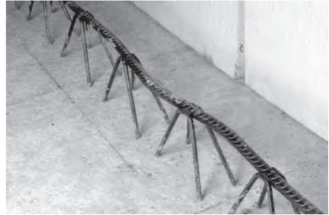
**Bild 25.** Knicken des Gitterträgerobergurtes als typisches Versagen in Versuchen zur Ermittlung der Biegetragfähigkeit aus [67]
