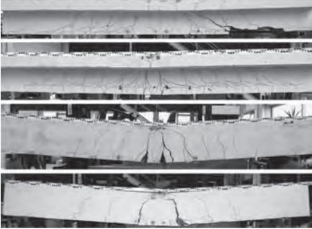
**Bild 65.** Rissbilder der Verbundbauteile mit Gitterträgern, Versuche zur Rotationsfähigkeit nach [96]
