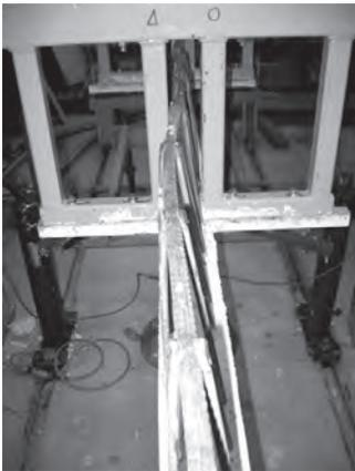
**Bild 39.** Seitliches Ausweichen hoher Gitterträger mit 10 cm schmaler Fußleiste nach [71]
