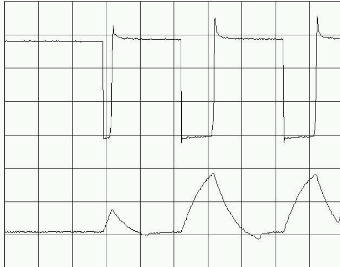
Oszillogramm 6. Angeschnittener Zündimpuls. Einstellungen wie Oszillogramm 5
