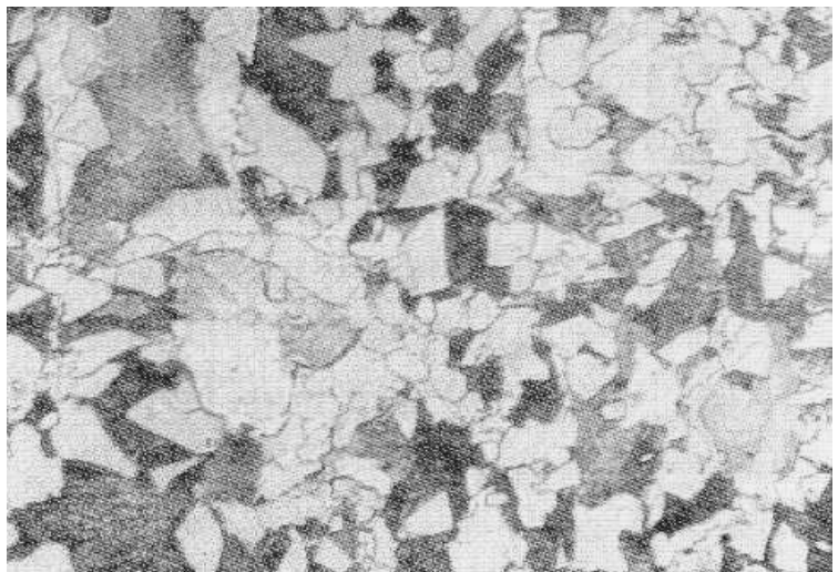
Bild 1 Gefüge aus Ferrit und Perlit
