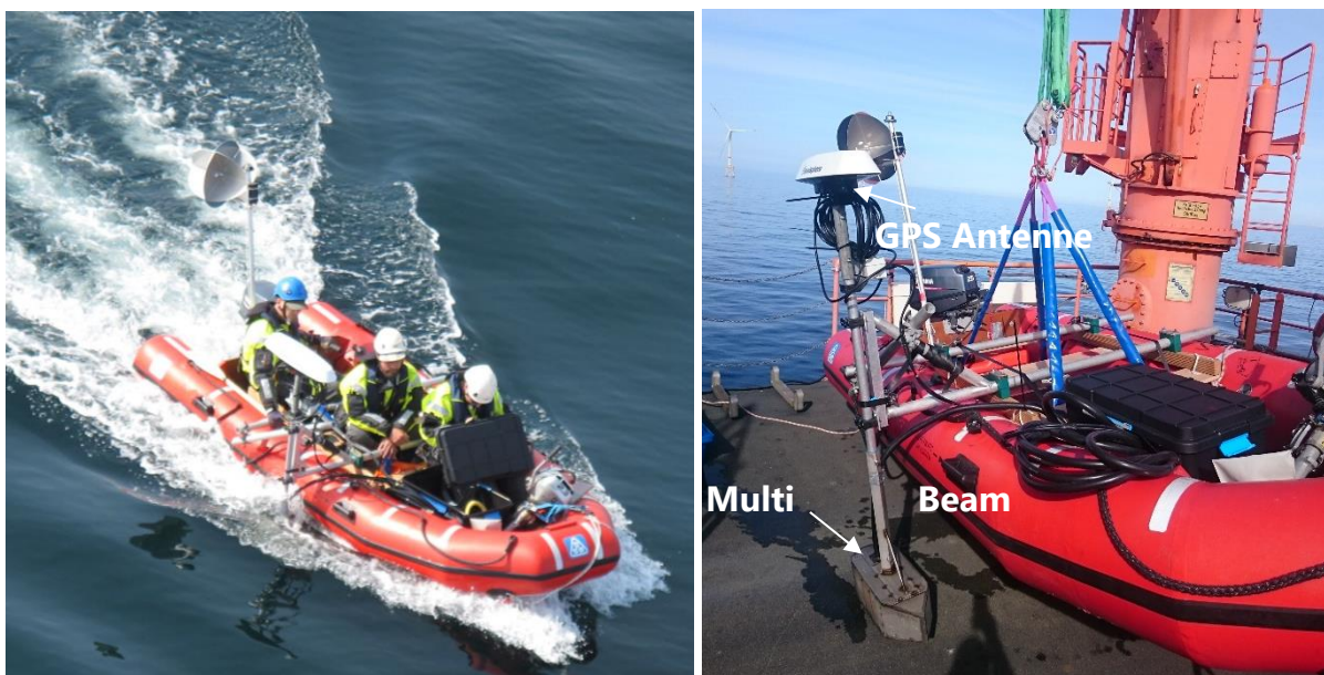
Abbildung 17: Motorboot mit MultiBeam Messaufbau
