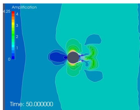
Abbildung 41: Verstärkungsfaktor bei 4 Meter Wellenhöhe für den Pfahl (oben), das Jacket (links) und das Jacket mit Kolkloch (rechts)
