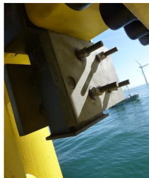
Abbildung 20: Testcoupons AlphaVentus; Quelle: " https://www.gigawind.de/tp3.html "
