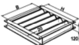
Die Klappen A (1250 mm lichte Breite, 310 mm lichte Höhe) gehen über den gesamten Gerätequerschnitt.
