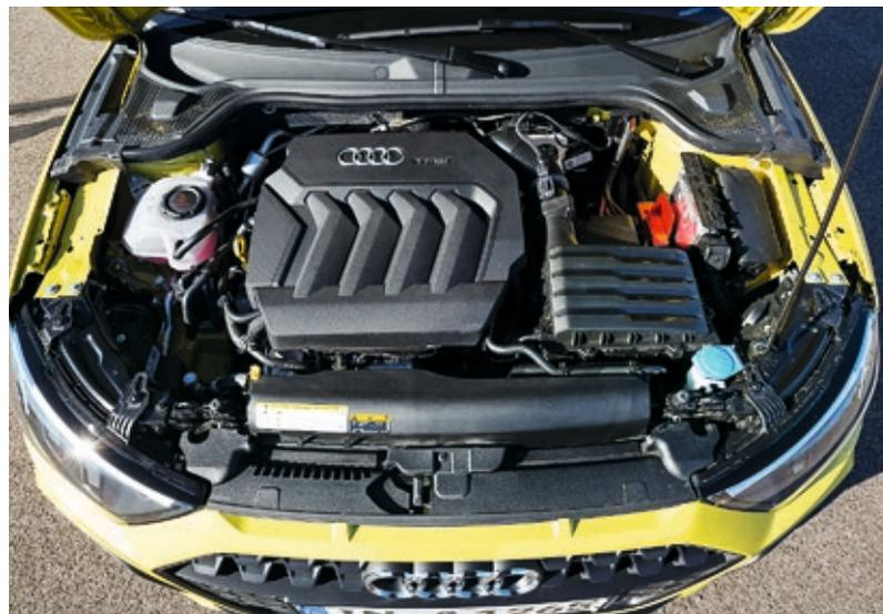
**Audi** | Antritts- und durchzugsstarker Zweiliter-TFSI, dessen 320 Nm leider ein wenig von der lang übersetzten S-tronic beschnitten werden
