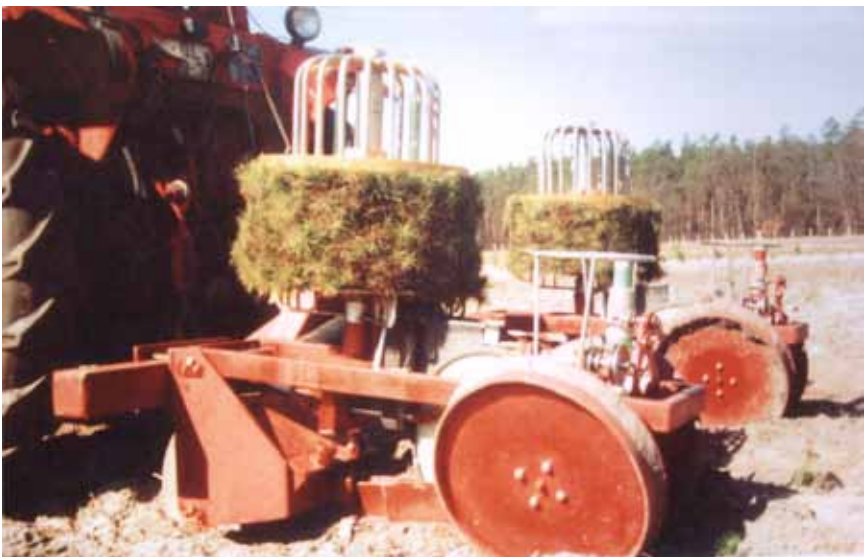
Abb. 2.12 Eine im Institut für Forstwissenschaften Eberswalde entwickelte Maschine zur großflächigen Aufforstung (Räum-Pflanz-Kombi). Sie räumt Hindernisse vom Pflanzstreifen und setzt die magazinierten Pflanzen fest in den Boden. Foto Siegfried Kopp. Mit ihr wurden u. a. Kippenböden nach Braunkohlenabbau zügig aufgeforstet. Vielfach wurde die Kiefer mit Erfolg zur Aufforstung von Kippen in Bergbaufolgelandschaften verwendet.
