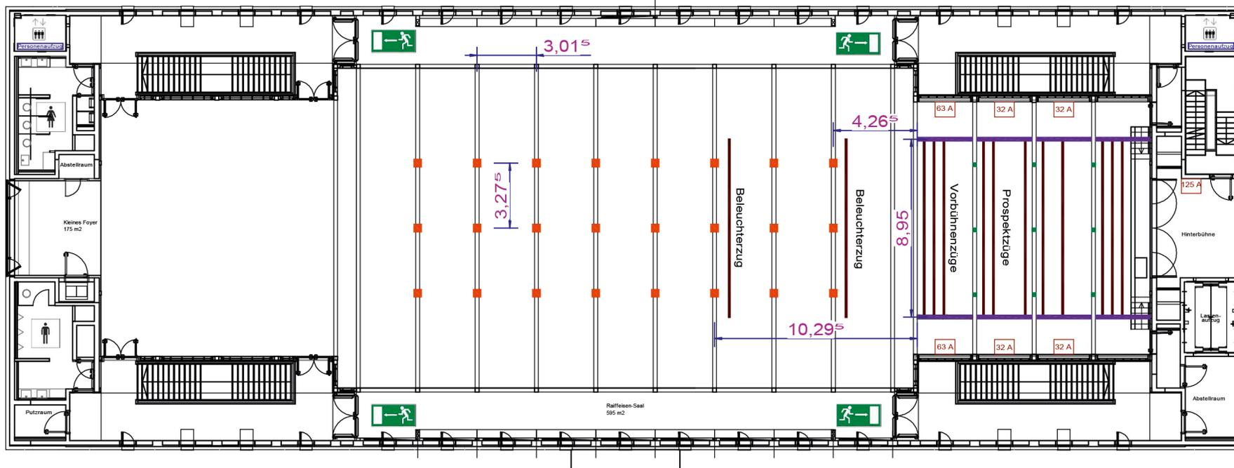
Lastpunkte Saal: maximale Einzellast  $F = 6,0$  kN Nutzlast ■
