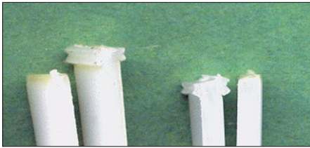
Bild 15: Bruchbild Schweißung Serie 5 , HS - IR-w, Emulsionstyp
