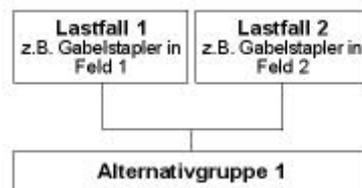
Die Lastfälle 1 und 2 werden der Alternativgruppe 1 zugeordnet, da sich der Gabelstapler entweder in Feld 1 oder in Feld 2 befinden kann.
