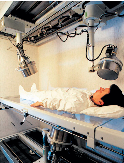
Ganzkörperzähler des Karlsruher Instituts für Technologie (KIT) zur Bestimmung gammastrahlender Radionuklide im menschlichen Körper.
