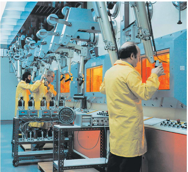
Heiße Zellen, Bedienseite mit Manipulatoren für fernbedientes Arbeiten.
