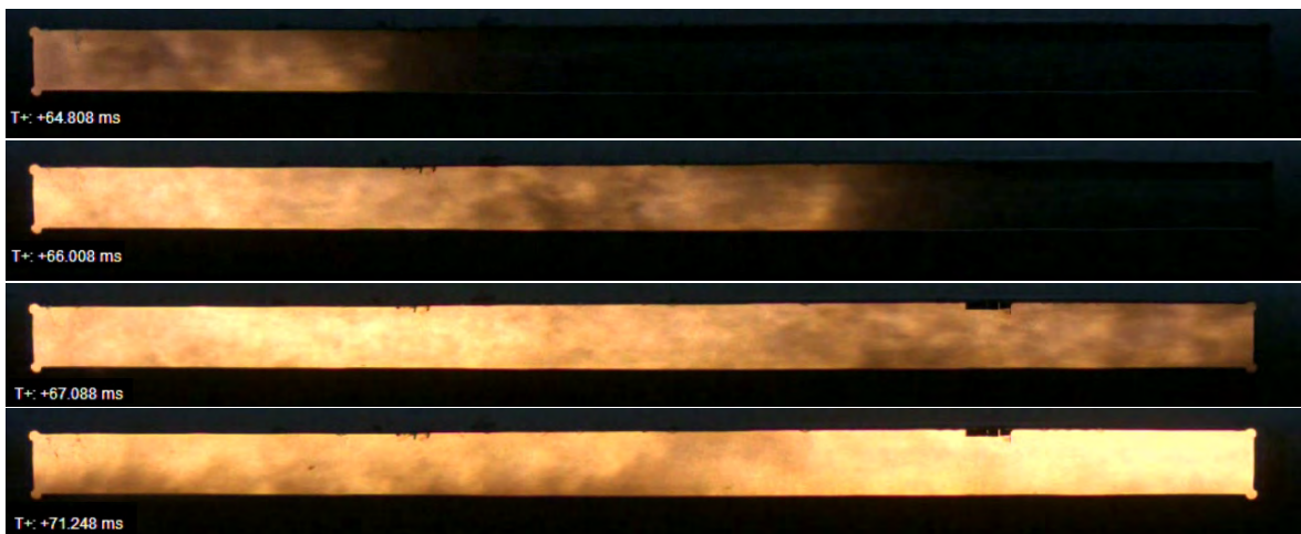
Abbildung 4.18: Bildsequenz einer Flammenfrontfortpflanzung in einer knapp 6 m langen DN 125-Rohrleitung, aufgenommen beim Test einer neuen Hochgeschwindigkeitskamera. Die Bildrate betrug 20.000 fps. Die Tests wurden durchgeführt mit c = 750 \text{ g/m}^3 und t_V = 0,5 \text{ s} .
