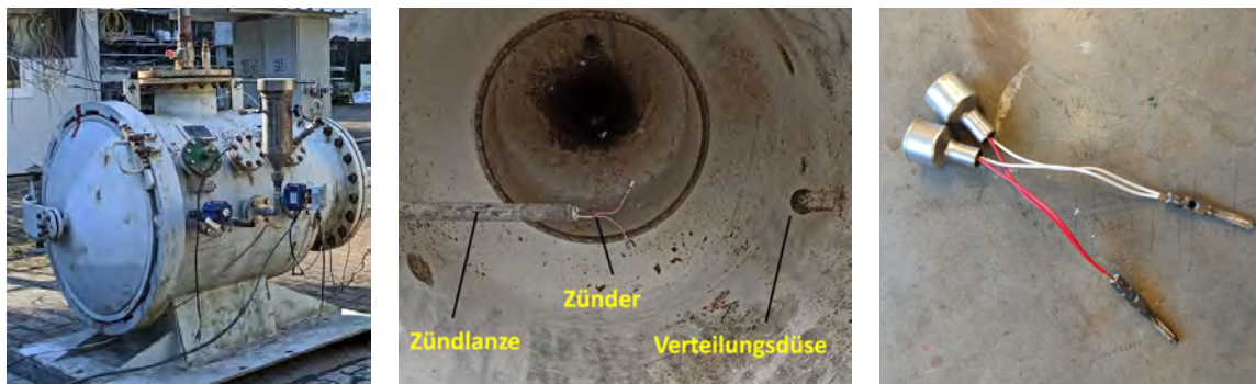
Abbildung 4.1: 1\text{ m}^3 -Behälter (links), Zündlanze, Zünder und Zerstäubungsdüse im 1\text{ m}^3 -Behälter (Mitte) sowie zwei parallel geschaltete pyrotechnische Zünder mit insgesamt 10 kJ Energieinhalt (rechts).
