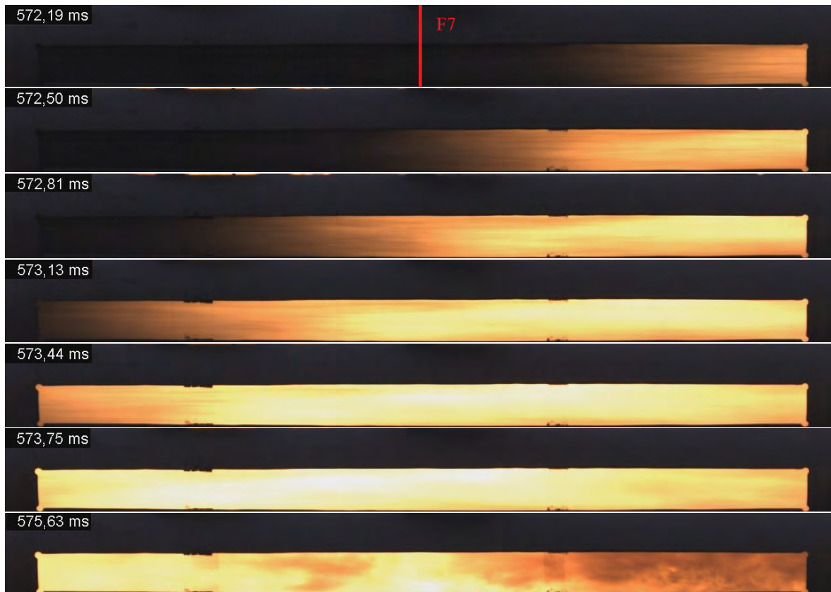
Abbildung 4.16: Flammenfrontfortpflanzung bei Versuch Nr. 55 (DN 125, c = 1000 \text{ g/}^3 , t_V = 0,5 \text{ s} ).
