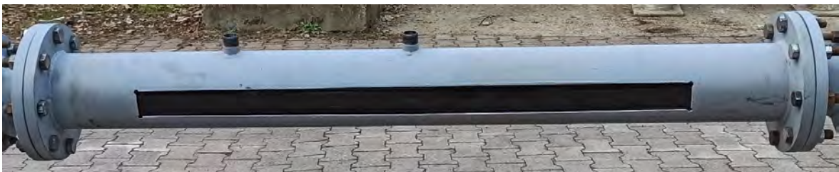
Abbildung 3.2: Mantelrohr mit eingeschobenem Glasrohr und Ausschnitt.
