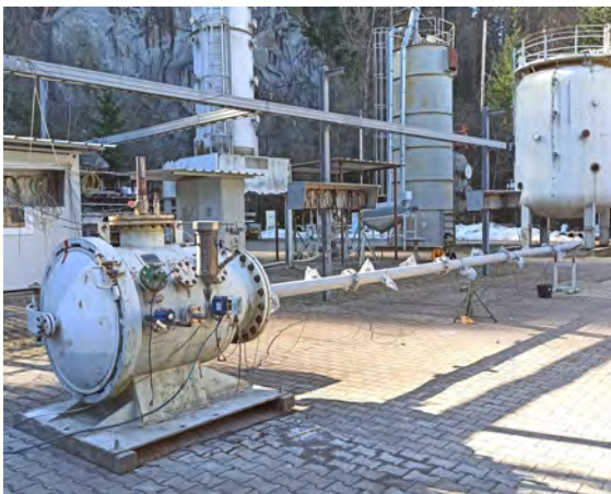
Abbildung 4.9: Impressionen von der Messkampagne im Februar und März 2021: Rohrleitung mit Sensoren (oben), ausströmendes Maisstärke/Luft-Abgas mit Machknoten (Mitte), Behälter mit Rohrleitung (unten, links) und Transientenrekorder mit Rechner zur Aufnahme der Signale von den Flammensensoren (unten, rechts).
