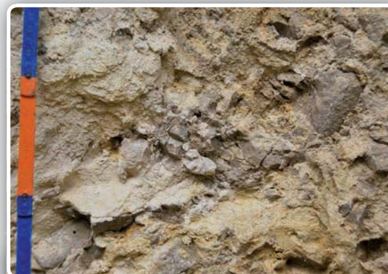
Bild 3 Mürber nicht umgelagerter Dolomitgrus westlich Steifling. Harte Dolomitsteine sind von weichem lockeren Dolomitsand umgeben. Maßstab: Farbabschnitt = 10 cm.
