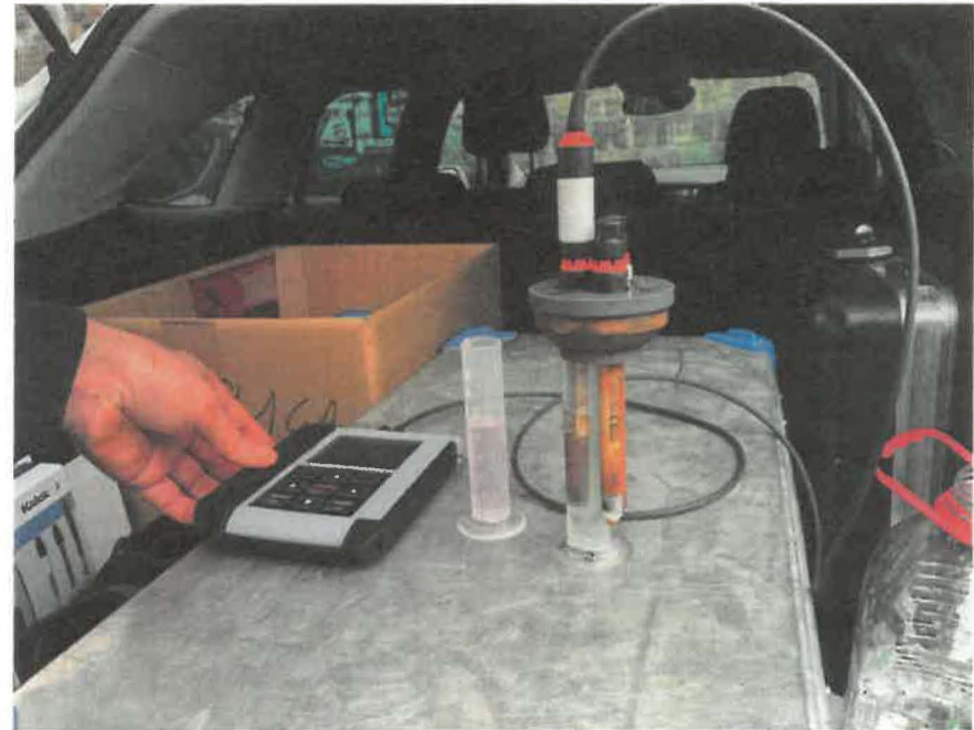
Abb.10 : Messsonde bei Wartungs- und Kalibrierarbeiten
